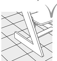
Для предотвращения опрокидывания у нашего стула на ножках имеются скользящие накладки. Они заставят стул скользить, а не опрокидываться в критической ситуации. Чтобы обеспечить надлежащее скольжение, стул должен находиться на гладкой и твердой поверхности. Родителям рекомендуется быть более внимательными, если стул стоит на шероховатых и ворсистых поверхностях.
