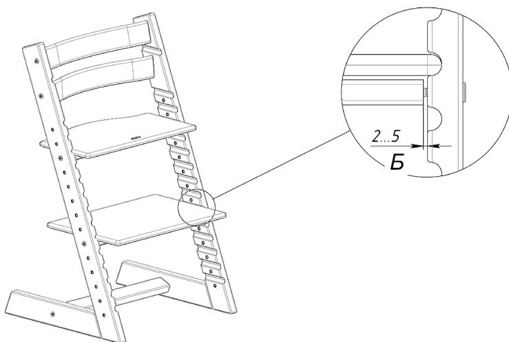
**ВАЖНО!** Не стоит прилагать большие усилия для устранения технологического зазора Б. Он нужен
